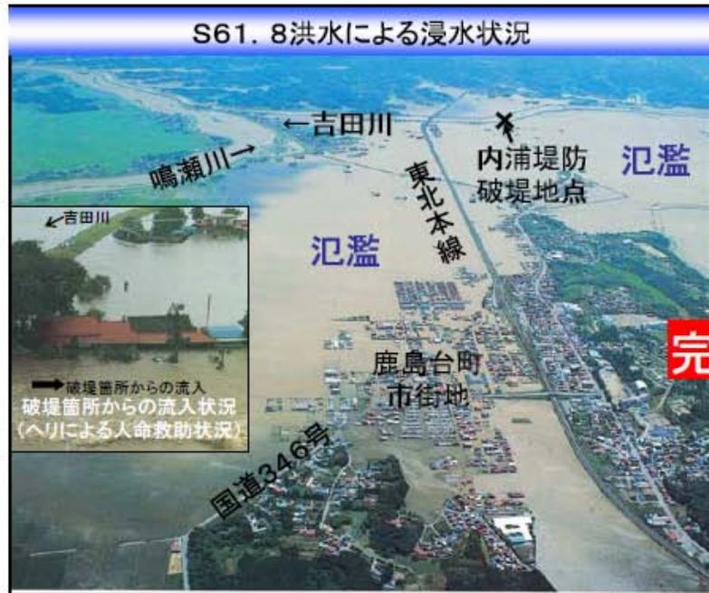
合計4箇所の破堤により、浸水面積は3,060ha、床上浸水家屋は1,510戸を数え、低平地など局所的に12日間も浸水した。
