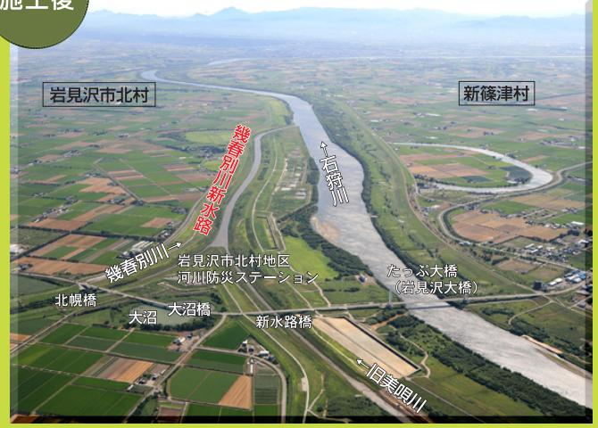
幾春別川に旧美唄川を合流し、計画高水流量1,400m<sup>3</sup>/sを流下させ、石狩川本川との合流点を5.4km下流に移すことにより、石狩川の背水の影響を軽減します。
