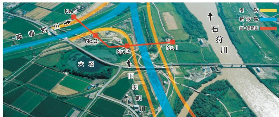
幾春別川と旧美唄川の河道切り替えで、機能に支障が生じる幌達布第1幹線用水路と美唄達布幹線用水路を、泥土式シールド工法を採用しサイフォンで両河川を横断させました。
