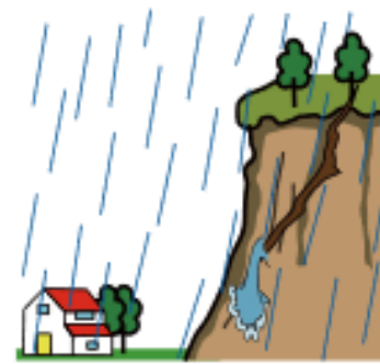
斜面から水の噴出し
