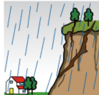
斜面のひび割れ
