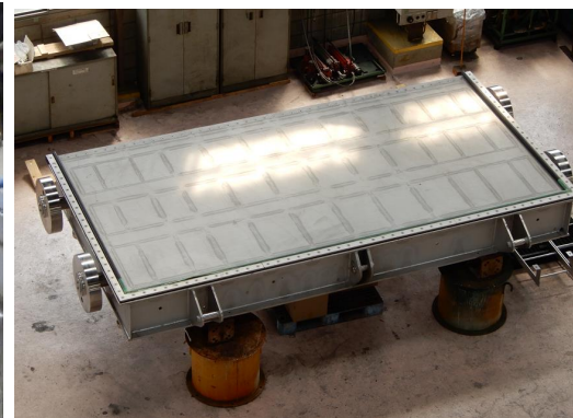
第1常用洪水吐ゲート 製作完了 令和4年3月撮影
