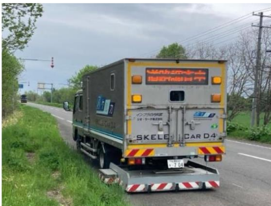
路面下空洞調査状況
