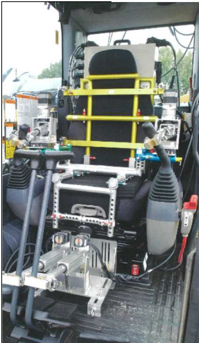
▲掘削機械（バックホウ）の操縦席への装着例
