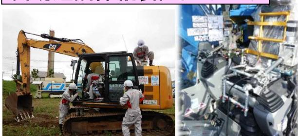
火山災害や土砂災害など危険な箇所では、汎用のバックホウにこの装置を装着して、遠隔操作による災害復旧作業が可能です。
