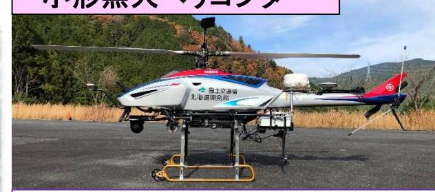
ラジコンヘリコプター及び移動操作車で構成し、有人飛行が制限されるような危険区域内にて災害状況及び被災範囲などを迅速に調査することにより、災害対策や応急復旧作業に有用な情報収集を目的とした機械です。
