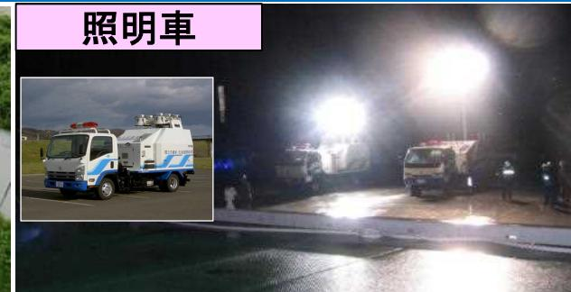
夜間の災害現場における作業員の安全確保や、被災現場の監視を行う際の照明として使用します。
