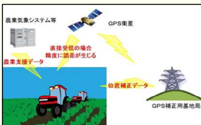
【GPSレベラー】【GPSガイダンス及び自動操舵システム】 【GPS位置データを活用】
