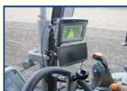
【GPSレベラー】【GPSガイダンス及び自動操舵システム】 【GPS位置データを活用】
