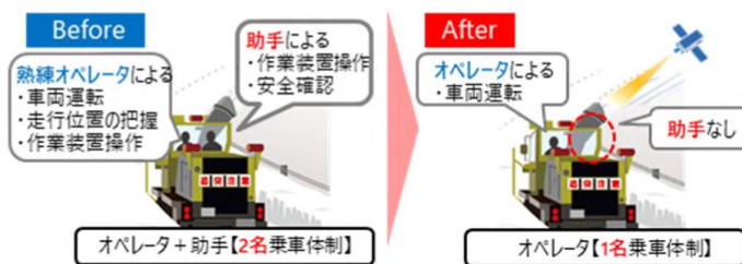
除雪現場の省力化イメージ
