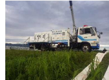
排水ポンプ車(妹背牛町)
