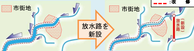
改修範囲・規模大 (放水路設置なし)
