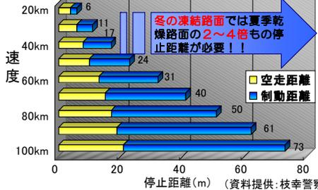
図は、一般的な自動車の夏季の停止距離と云われています。冬季は、これより停止距離が長くなるので、更なるスピードダウンが必要でしょう。
